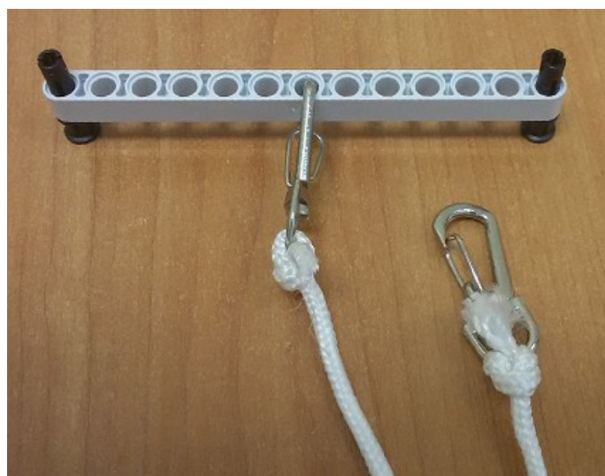
Рис. 4. Пример крепления каната к деталям робота
