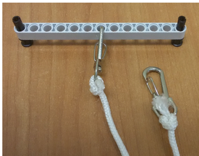
Рис. 4. Пример крепления каната к деталям робота
